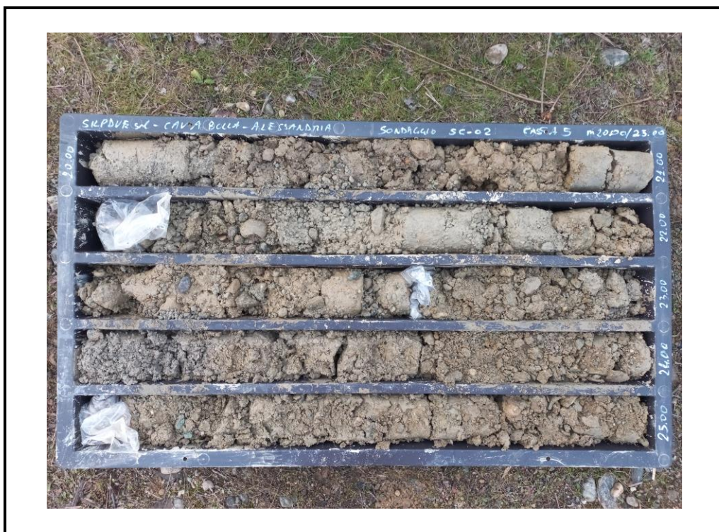
Foto 11: Sondaggio SC-02 - cassa 5 - da 20.00 m a 25.00 m.
