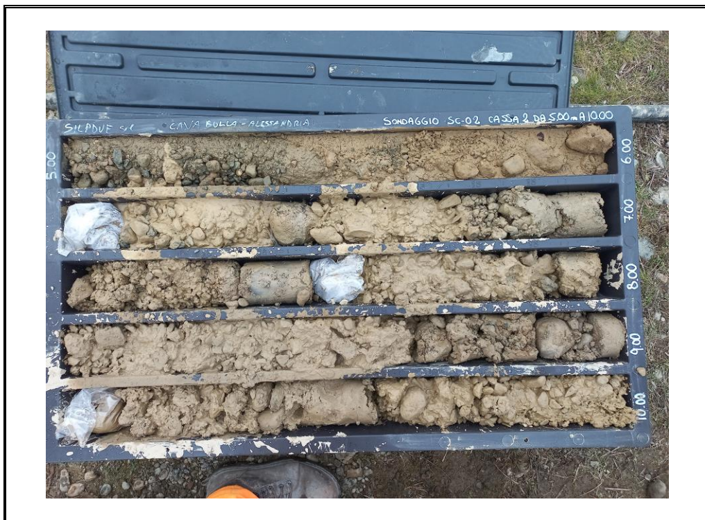
Foto 8: Sondaggio SC-02 - cassa 2 - da 5.00 m a 10.00 m.
