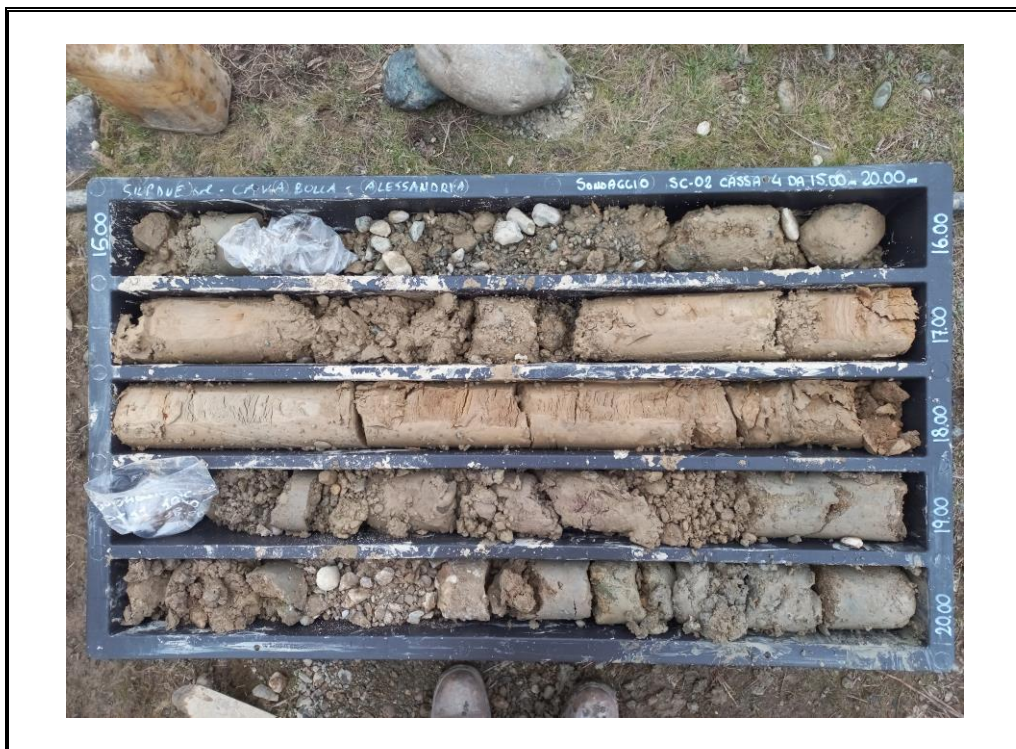
Foto 10: Sondaggio SC-02 - cassa 4 - da 15.00 m a 20.00 m.
