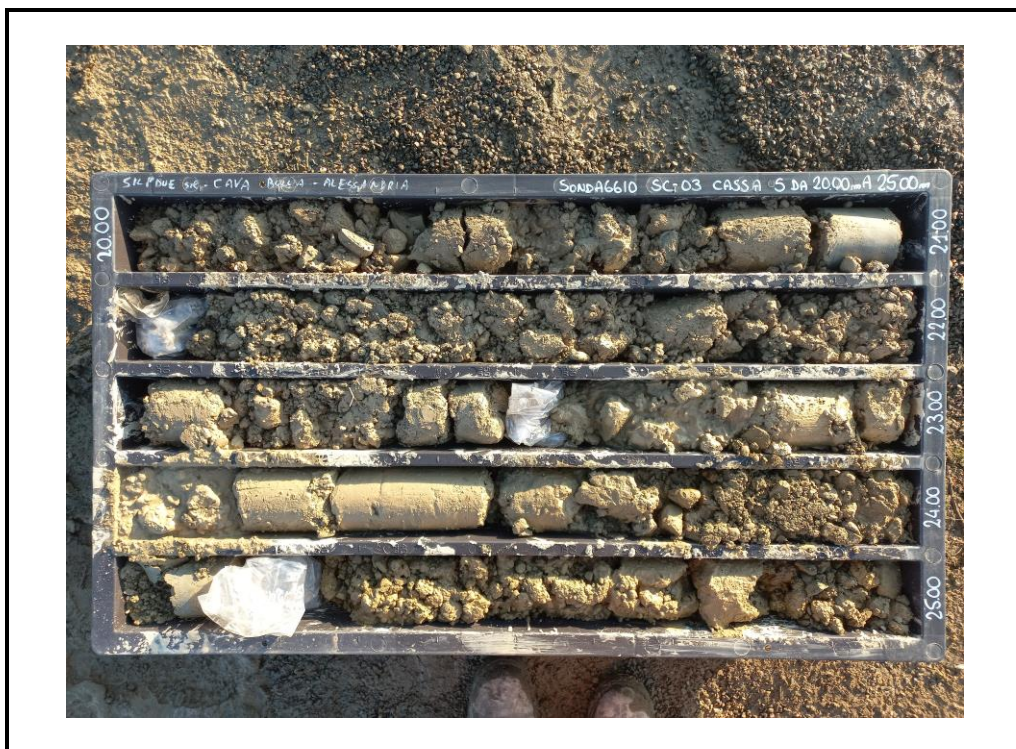
Foto 17: Sondaggio SC-03 - cassa 5 - da 20.00 m a 25.00 m.
