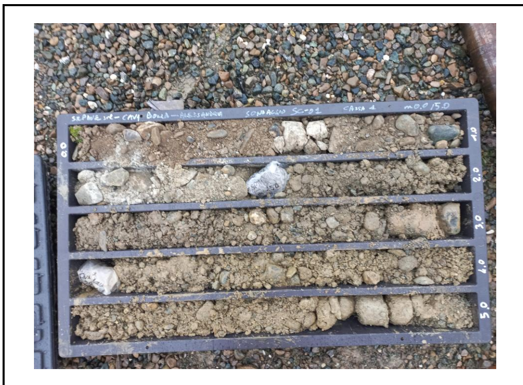
Foto 1: Sondaggio SC-01 - cassa 1 - da 0.00 m a 5.00 m.
