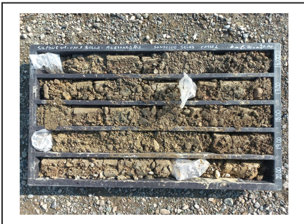
Foto 4: Sondaggio SC-01 - cassa 4 - da 15.00 m a 20.00 m.
